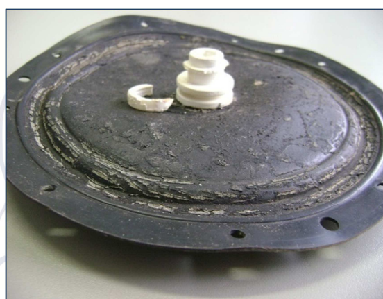
Figura 23 – Degradação das cápsulas plásticas - esbranquiçadas (esquerda). Deterioração do diafragma do Regulador de Pressão (direita)
