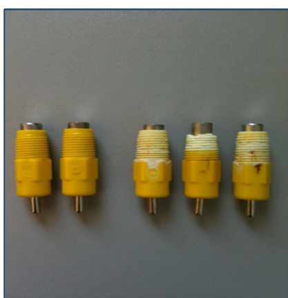
Figura 23 – Degradação das cápsulas plásticas - esbranquiçadas (esquerda). Deterioração do diafragma do Regulador de Pressão (direita)
