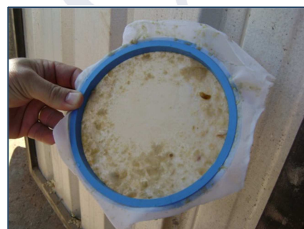
Figura 29 – Após a limpeza do sistema com Evacide, a água eliminada pode conter muita sujeira liberada da tubulação
