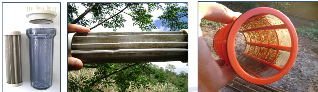
Figura 18 – Filtro de água. Amostra limpa (esquerda). Cartuchos sujos podem contaminar a água e reduzir a vazão (centro e direita)
