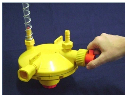
Figura 16 – Operação do Regulador de Pressão. Flushing: giro anti-horário (esquerda) e controle da coluna de água: giro horário (direita)
