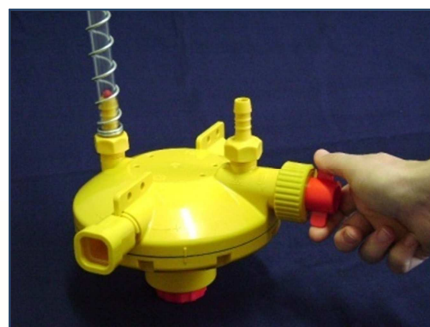
Figura 16 – Operação do Regulador de Pressão. Flushing: giro anti-horário (esquerda) e controle da coluna de água: giro horário (direita)
