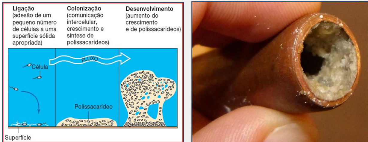
Figura 21 – Diagrama da formação do biofilme (esquerda). Biofilme no interior de um tubo (direita).
