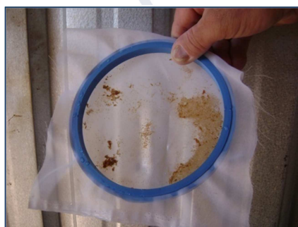
Figura 29 – Após a limpeza do sistema com Evacide, a água eliminada pode conter muita sujeira liberada da tubulação
