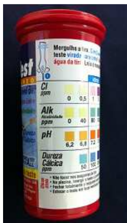
Figura 20 – Escala de cor em fita reagente para dosagem rápida de cloro ativo
