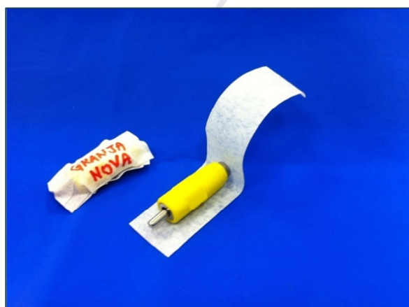
Figura 25– Amostras de nipples para laboratório embaladas com fita crepe, preservando o conjunto original de campo.
